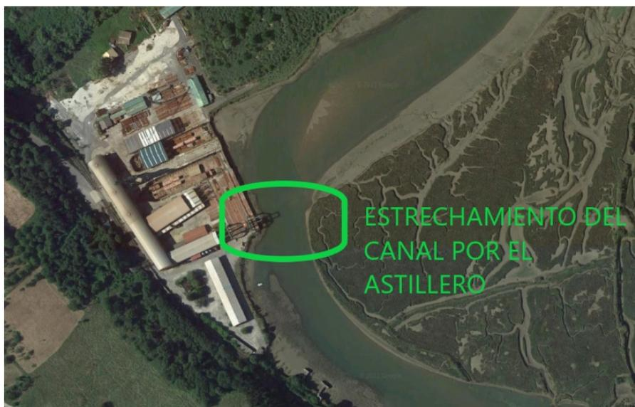
**Figura 53.** *Identificación de la zona de estrechamiento del canal debido a la presencia del Astillero de Murueta*
